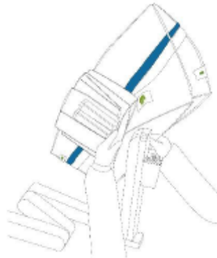
Figura 6.5 Instalação do Campo Estéril do Braço de Instrumentos
