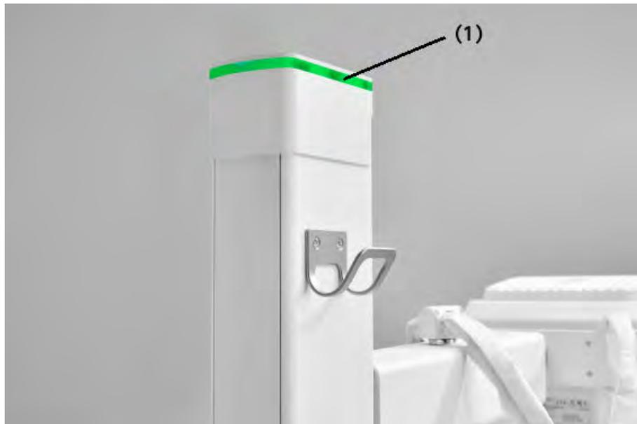
O sistema é fornecido com o indicador luminoso de status (1), localizado na parte superior da Coluna, que indica diferentes status do sistema por cores, conforme descrito na tabela a seguir.
