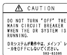
⑨ Rótulo de cuidado de disjuntor
